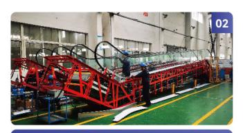
利用完整的模块化的桁架,在工厂预安装。除此以外的装配与传统的扶梯方式完全一样。
