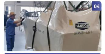
EME出厂时,整机已拆解为各模块,以及导轨、扶手系统等部件, 且独立包装,为现场快速安装做好准备。
